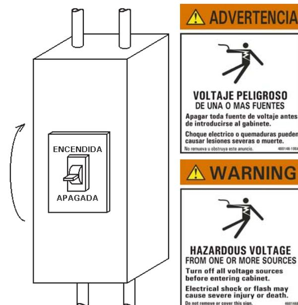
**Figura B5.** ENCENDER la energía del control
